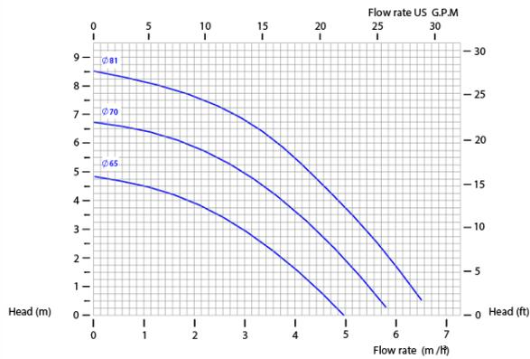
Le curve ed i valori prestazionali si riferiscono a pompe a mandata libera con acqua a 20 °C e motore bipolare 50 Hz. Questi dati possono variare in funzione dei materiali di costruzione e delle condizioni idrauliche.
